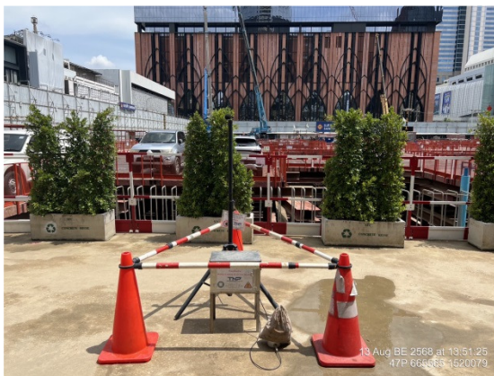
ภาพที่ 28 เครื่องตรวจวัดความสั่นสะเทือน
