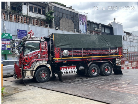
ภาพที่ 18 การปิดคลุมรถบรรทุกด้วยผ้าใบทึบ
