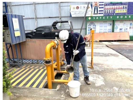
ภาพที่ 38 การเก็บตัวอย่างน้ำเพื่อตรวจสอบ
